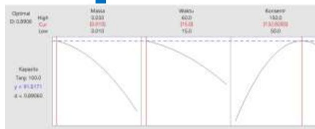
Gambar 6. Plot Optimasi Hasil RSM BBD untuk Kapasitas Adsorpsi.
