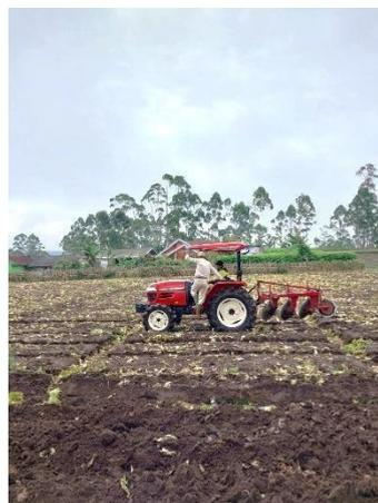
Gambar 1. Penggemburan tanah menggunakan traktor roda empat
